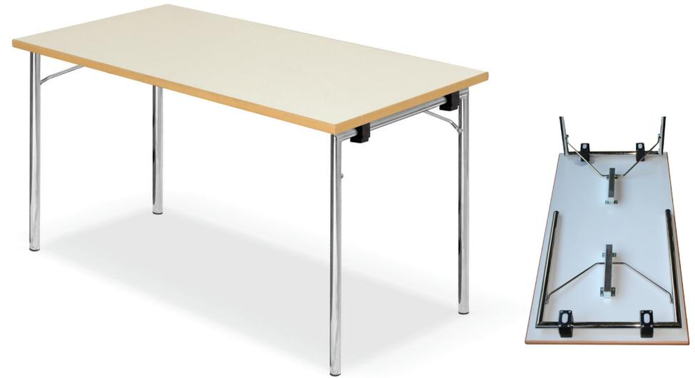
Abb. zeigt Klapptisch Modell DEMUS 3 Vierfußgestell **auf Gehrung mit Bügel**, verchromtes Rundrohrgestell 40 x 2 mm Ø, Höhenverstellung am Fuß, **HPL-Schichtstoffplatte 30 mm stark**, Tischplatte Buche, **Buche Massivholzkante B**, Maß: 150 x 70 cm
