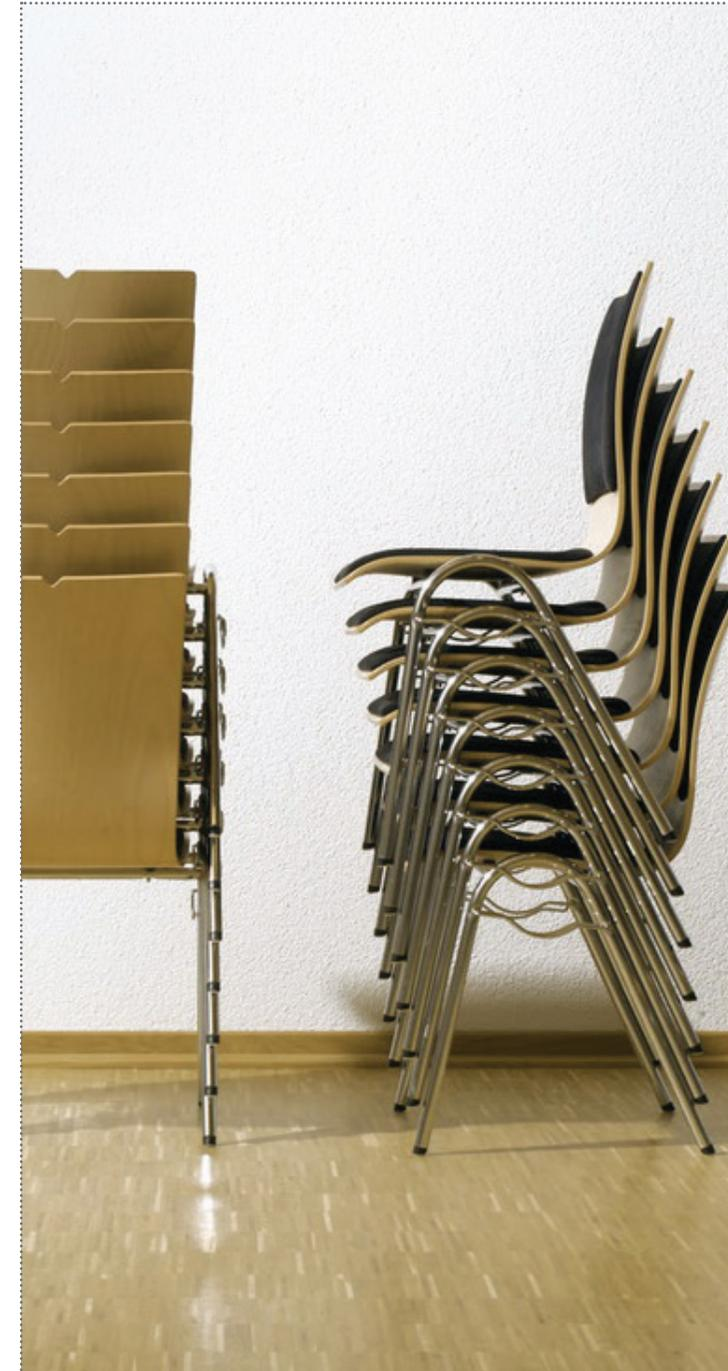
Präzisions-Stahlrohr 22 x 1.6 mm, parabelartige Seitenrohre, extra stark verchromt mit 25 µ, mit patentiertem Stapelsteg zur kipp-sicheren, senkrechten Stapelung von bis zu 20 Stühlen, mit nichtschmierenden Bodengleitern. Lordoseunterstützung in Buche-Schichtholz aus hochdruckverpressten Buchenfurnieren mindestens 10 mm stark, mindestens 9 Lagen.
